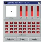
根据黄色的提示去完成校准。当你点击按钮,将显示另外下一段提示:当校准完成后,出现一条绿色的信息告知各项操作正常。根据你是想保存还是取消校准,分别点击 apply 或者 cancel 按键。任意操作将回到测试屏幕。
